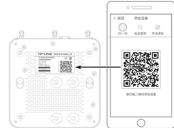
3.NVR添加完成后，输入NVR的管理密码，选择NVR下已连接的IPC，并将其绑定到APP上的相应通道，即可在“预览”界面看到监控画面。
