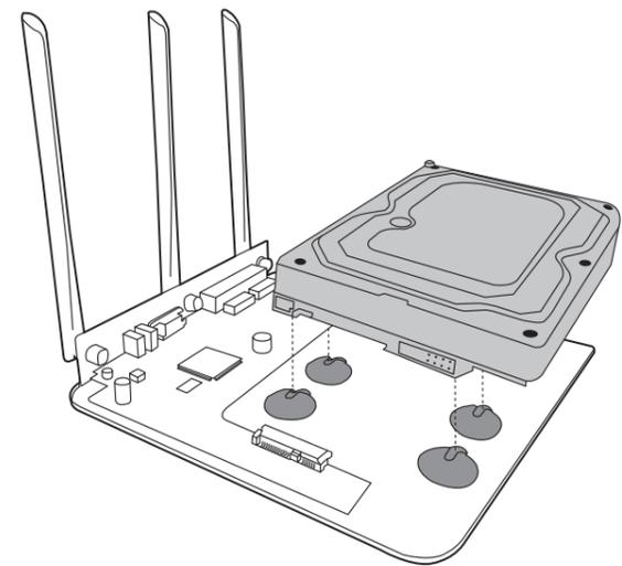
3. 推动硬盘, 将硬盘插入对应的硬盘插座中。
