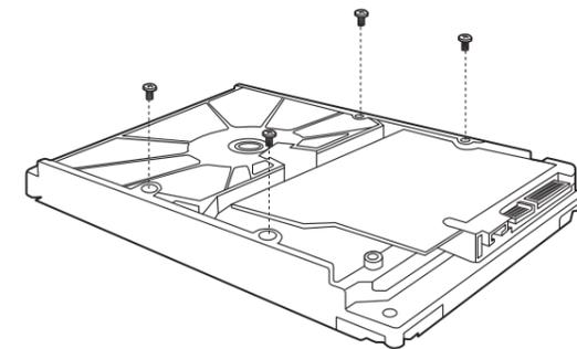
2. 打开机箱上盖, 再将硬盘上的螺丝对准机箱底部预留孔。
