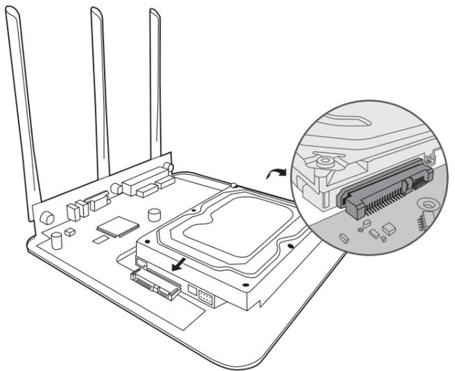
4. 拧紧硬盘固定螺丝, 再将机箱上盖安装回设备, 硬盘安装完成。
