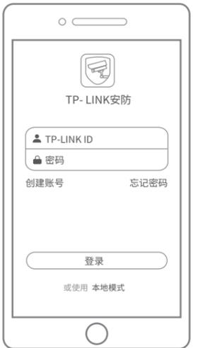
2.登录“TP-LINK安防”APP，进入添加设备界面，选择“扫一扫”可扫描产品底部标贴上的二维码快速添加NVR。也可以选择自动发现或手动添加的方式添加NVR。
